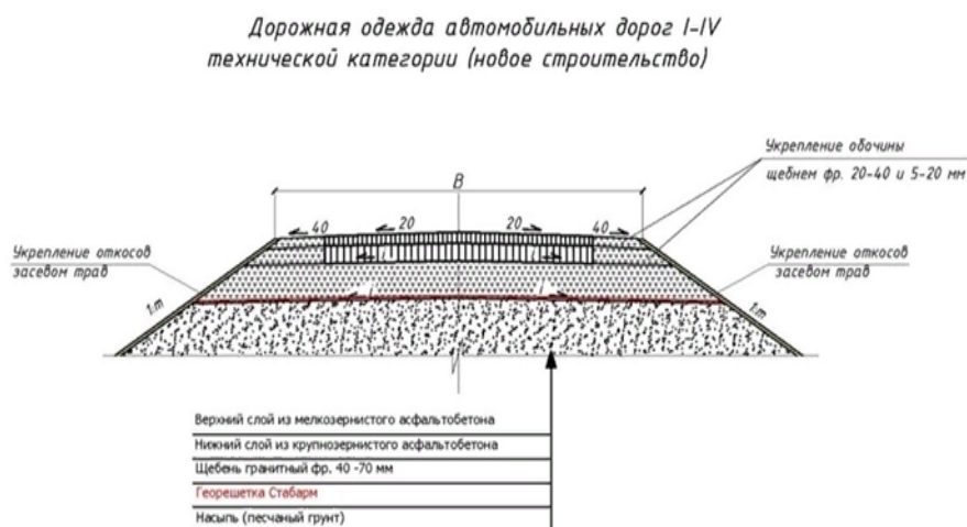
Рисунок 4. Земляное полотно и дорожная одежда
